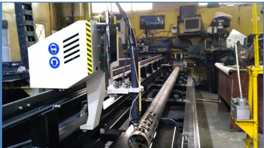
**Все электрические гибкие кабели, применяемые на станке, экранированные, пр-ва LAPP GROUP (Германия).**
