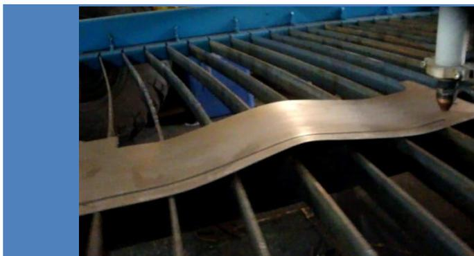
Принцип работы контроля высоты основан на измерении напряжения дуги плазматрона при его работе. В связи с этим нет необходимости в установке на резак дополнительных неудобных тарелок и внешних навесок.
